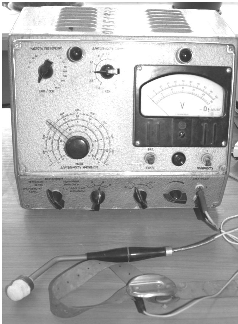
Рис. 4. Зовнішній вигляд хронаксиметра з електродами
