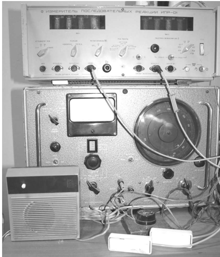
Рис. 8. Обладнання для визначення прихованого (латентного) періоду простої аудіо-моторної реакції
